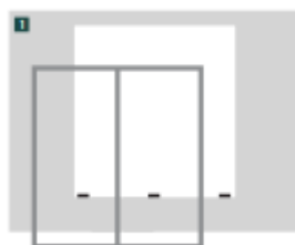
Fig. 1 Døre og vinduer skal altid stilles på egnet opklodnings- materiale
