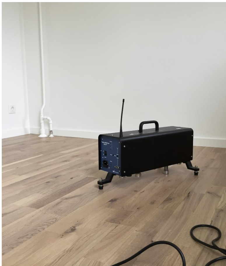
Figur 4.2 Måleopstilling ved måling af trinlydniveau.
